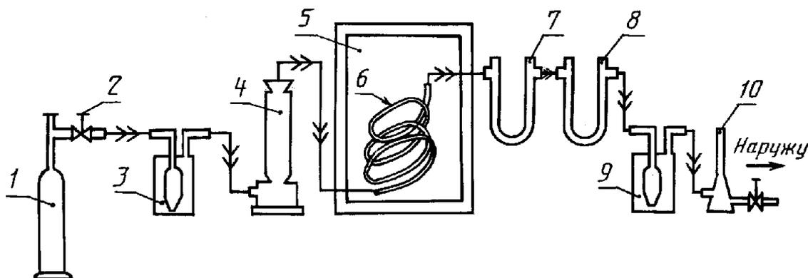
Баллон, заполненный азотом, содержащим не более 0,5 % объема кислорода.
