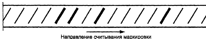
Рисунок 2 — Пример прокатной маркировки предприятия-изготовителя под номером 14
